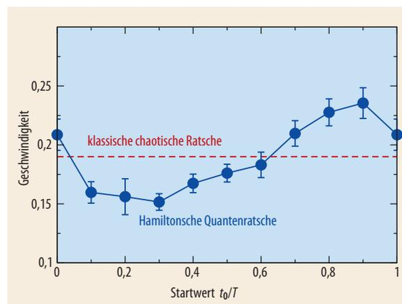
Abb. 2 Die gerichtete Geschwindigkeit eines Bose-Einstein-Kondensates hängt charakteristisch vom Startwert  $t_0$  der zeitlichen, periodischen Modulation ab. Eine Mittelung über diesen Startwert  $t_0$  ergibt einen endlichen Wert. Im Gegensatz dazu ist für eine klassisch chaotische Ratsche die gerichtete Bewegung ergodisch, womit diese Abhängigkeit von  $t_0$  entfällt.
