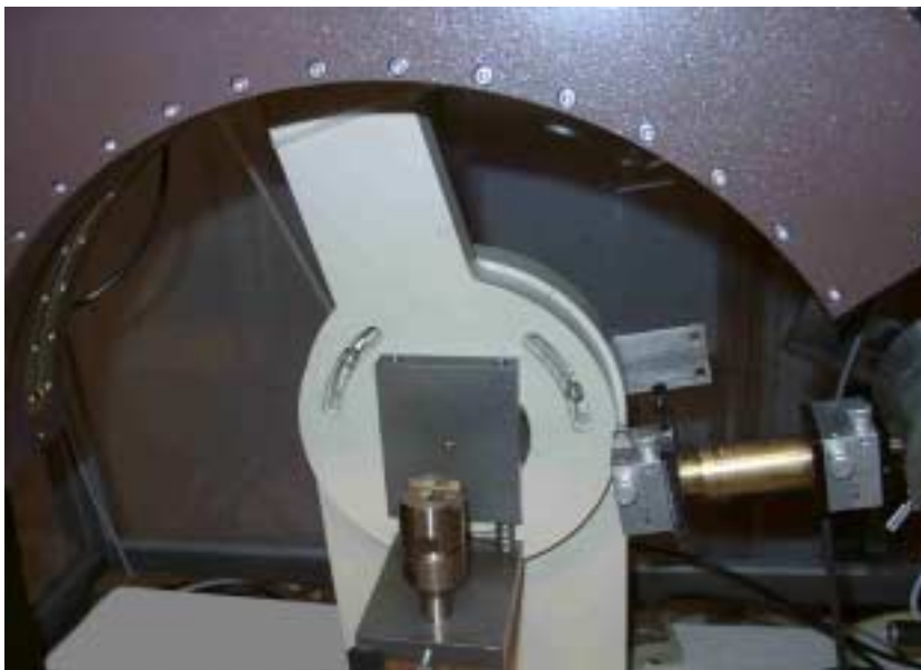
Abbildung 4.8 : Versuchsanordnung zur Röntgendiffraktometrie. Oben: schematisch, unten: Foto.
