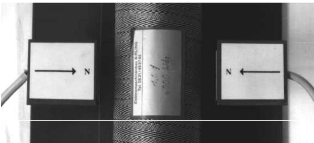
Abb. 24 Ausrichtung der Sonden senkrecht zur Spule
