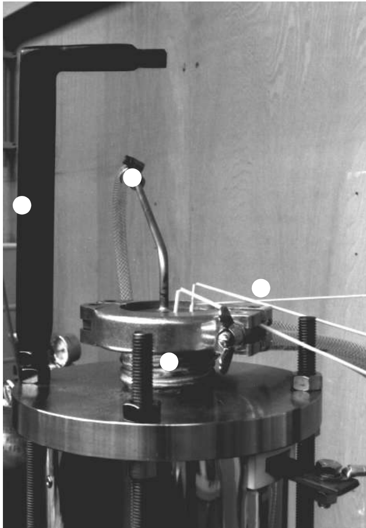
Abb. 13 Detailansicht des Ofenoberteils: 1 Probenhalter (Galgen); 2 Formiergaseinlaß; 3 Kühlschlangen; 4 Thermoelemente für die Steuerung
