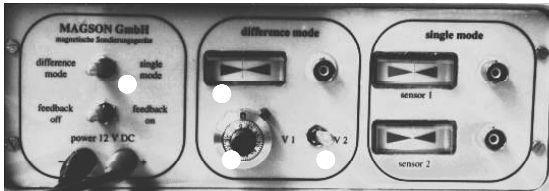
Abbildung der Anzeige des Magnetometers mit (1) Modusschalter, (2) Differenz-Modus-Anzeige, (3) Empfindlichkeitsschalter, (4) Nachjustierskala
