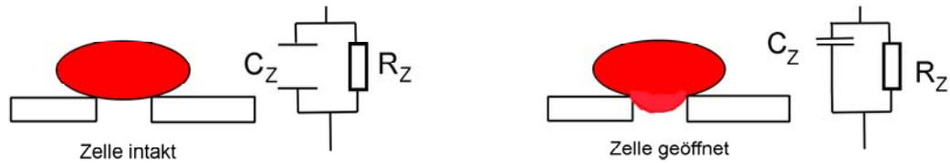
Abb. 7.1: Nachweis der Zellöffnung durch Messung der Kapazität und des Widerstands über die Zelle. Sobald die der patch Öffnung näher liegende Zellmembran geöffnet ist, steigt die Kapazität stark an und der Widerstand sinkt.
