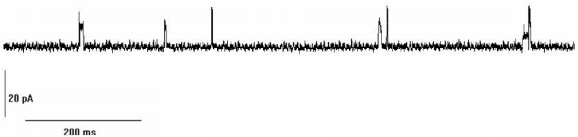
Abb. 4.3: Ausschnitt einer Stromspur von D15PC/DOPC bei T = 40^{\circ} \text{C} in der fluiden Phase. Wiederum treten – wenngleich auch seltener als bei T = 38^{\circ} \text{C} - Stromspitzen im Bereich von ca. 10 – 20 pA auf. Die Klemmenspannung beträgt hier U = 100 \text{ mV} .
